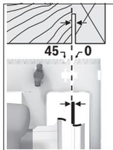
La marca de corte 0° (9) muestra la posición de la hoja de sierra en caso de corte rectangular. La marca de corte 45° (8) muestra la posición de la hoja de sierra en caso de corte de 45°. Para obtener un pieza con las medidas correctas, alinee la sierra respecto al trazo según se muestra en la figura. Se recomienda realizar un corte de prueba.
