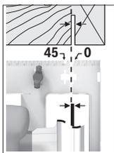
A marcação de corte 0° (9) indica a posição do disco de serra no corte em ângulo reto. A marcação de corte 45° (8) indica a posição do disco de serra no corte em 45°.
